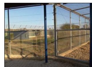
metálica de simple torsión de unos 3m de altura, con un voladizo de 1m en un ángulo de unos 45° hacia el interior. Existen dos líneas de pastor eléctrico, en la parte inferior y superior del voladizo, que, en caso necesario, se pueden desconectar independientemente en cada jaula. El área de campeo es accesible para el personal desde el pasillo central, a través de una puerta de una sola hoja, junto a la cual se halla el chivato de funcionamiento del pastor eléctrico.
